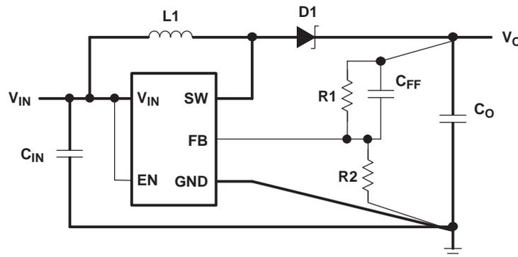
**Figure 15. Layout Diagram**
