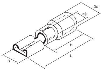
поперечное сечение провода 4~6mm<sup>2</sup> I<sub>max</sub>=24A
