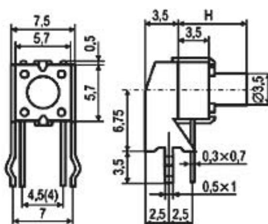
\*У кнопок SWT-42 размер H равен 4.3, 5.0, 7.0, 8.0, 9.5, 12.5 мм.
