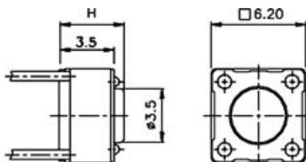
\*У кнопок SWT-14 высота H равна 4.3, 5.0, 7.0, 9.5, 13.0 мм.
