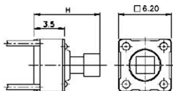
\*У кнопок SWT-15 высота H равна 4.3, 5.0, 7.0, 9.5, 13.0 мм.
