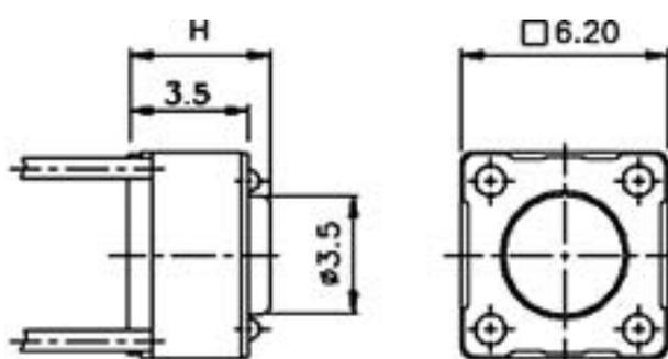
У кнопок SWT-20 высота H равна 4.3, 5.0, 7.0, 8.0, 9.5 мм.
